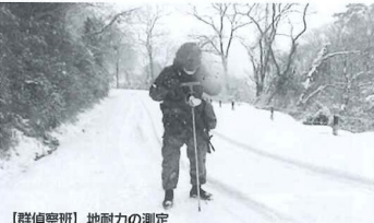
【群偵察班】地耐力の測定
